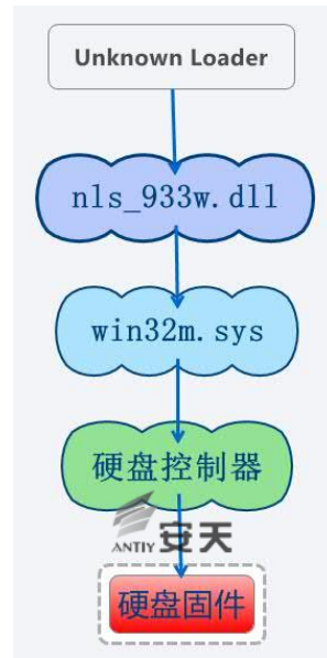
图 5 修改硬盘固件的流程图
