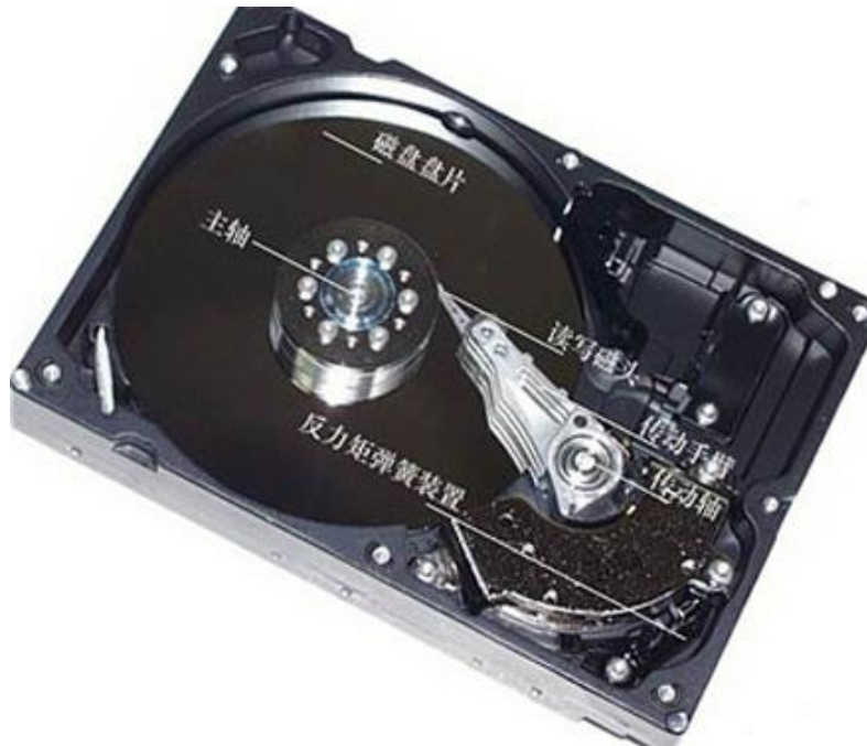
图 9 机械硬盘组成与结构
